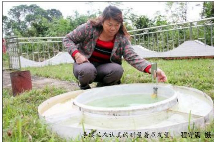
李瑞兰在认真的测量着蒸发量。程守满 摄
